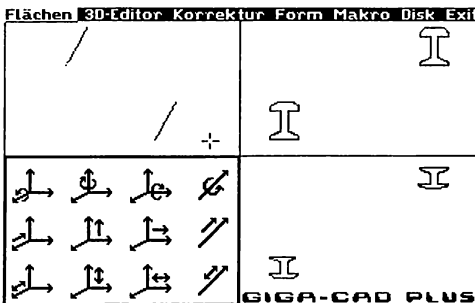
Bild 1.17: Zur Veranschaulichung der Funktion »Flächen verbinden« hier die drei Projektionsansichten einer Fläche
