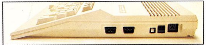
Bild 7. Anschlüsse und Schalter an der rechten Seite: Netzteilanschluß, Einschaltknopf, Reset-Taster, Joystick-Ports 2 und 1
