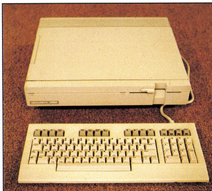
► Bild 8. In der Version PC 128 sind Computer und 1571-Floppy im selben Gehäuse untergebracht
