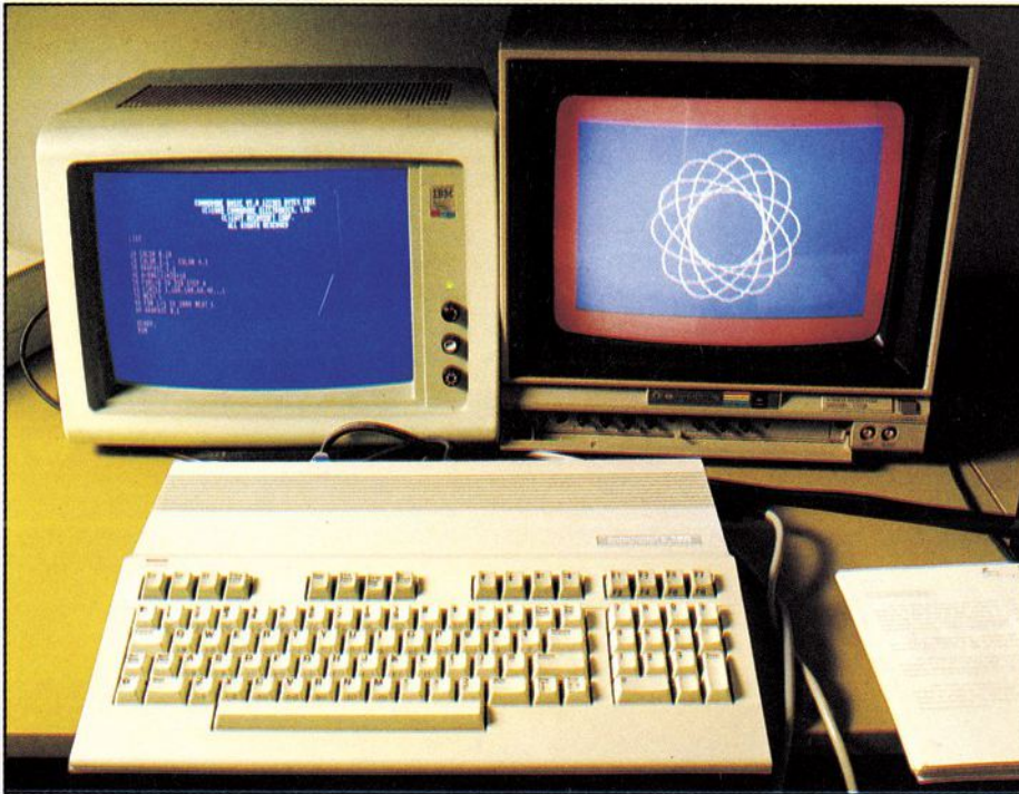
Bild 9. Der PC 128 mit RGB- und Composite-Monitor. Links das Programm und rechts die dadurch erzeugte Grafik.
