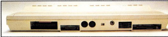
Bild 4. Der PC 128 von hinten gesehen. Von rechts nach links: User-Port, RGB-Ausgang, Fernseher, Composite Video, Serieller Port, Datensetten-Anschluß, Expansion-Port für Steckmodule
