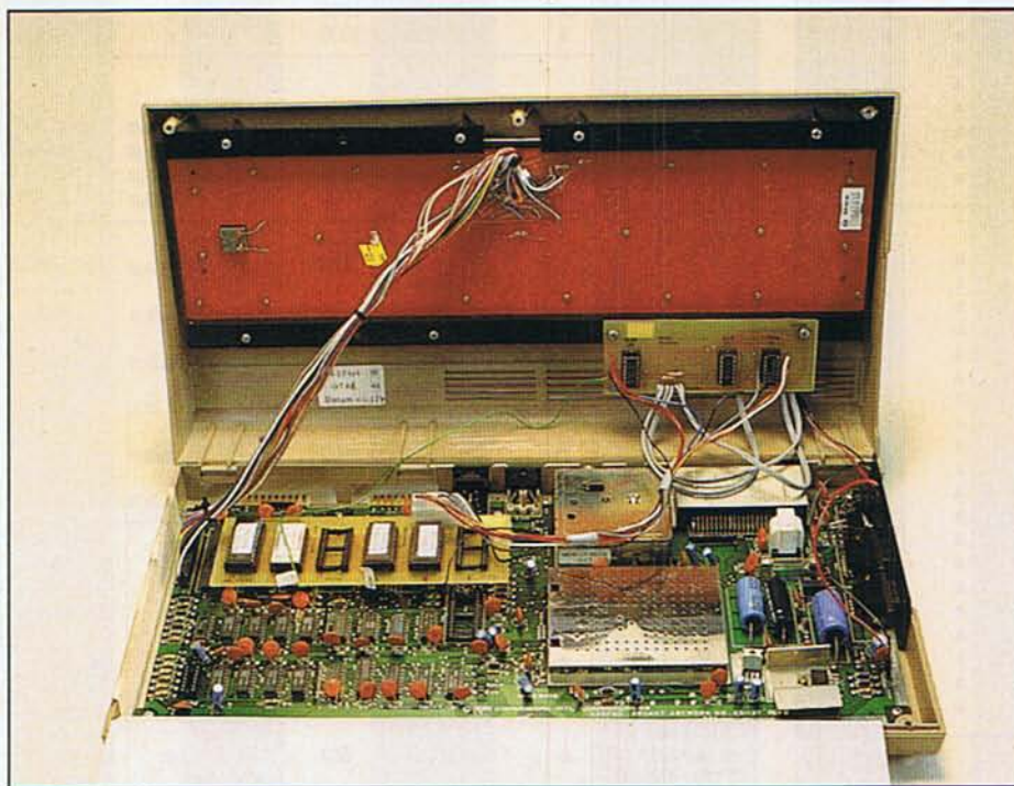
Bild 6. So wird EPROM-Trans in den C 64 eingebaut
