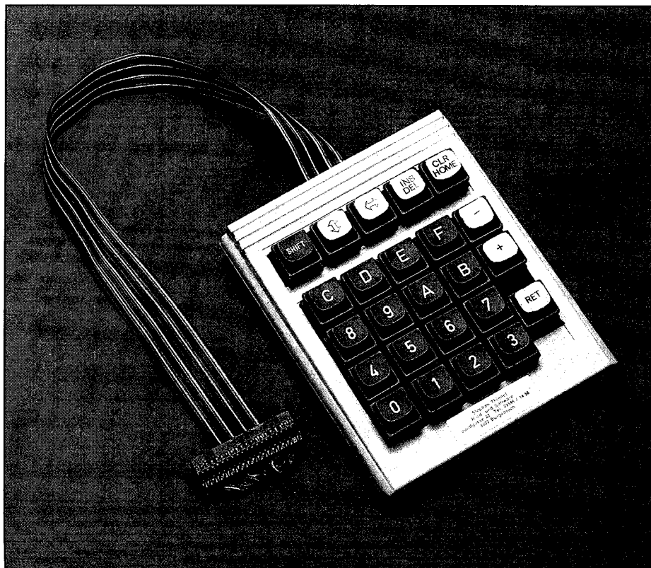
Bild 3. Ein Prototyp der Hex-Tastaturen. Eine von uns testweise zusammengebaute Version. Für die RETURN-Taste sollte eine doppeltgroße Tastenkappe die Eingabe erleichtern.
