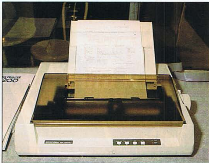
Der Schnelle: Bis zu 300 Zeichen pro Sekunde schafft der MP 1300 AI
