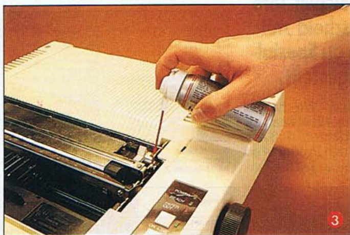
Dritter Schritt: Nun kann man den Staub aus den Innereien des Druckers entfernen.
