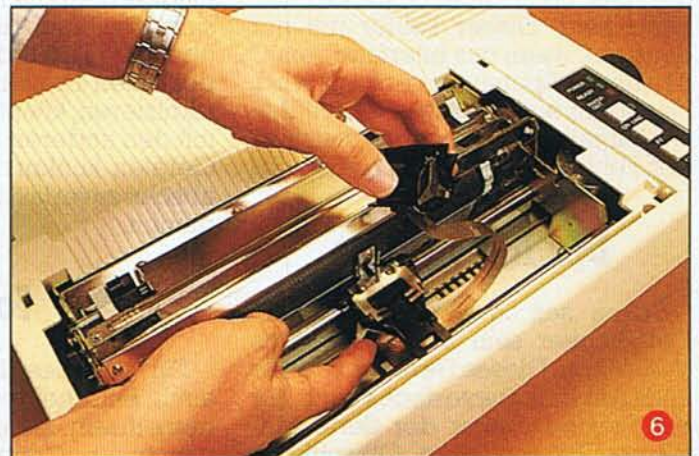
Sechster Schritt: Der Druckkopf muß zur Reinigung vorsichtig ausgebaut werden.
