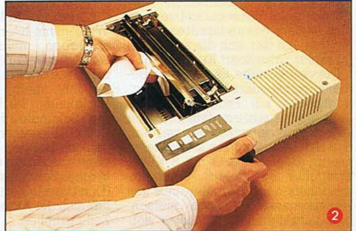
Zweiter Schritt: Die Papierwalze muß ebenfalls gründlich gesäubert werden.
