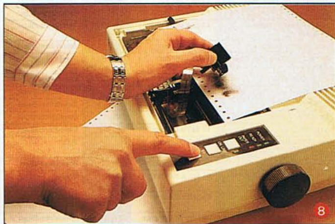
Achter Schritt: Der Selbsttest des Druckers schleudert den Dreck aus dem Druckkopf.
