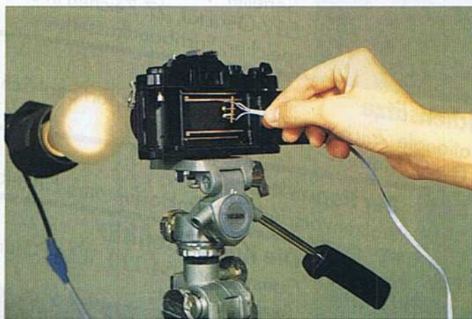
Bild 1. So können Sie Verschlusszeiten einer Fotokamera überprüfen
