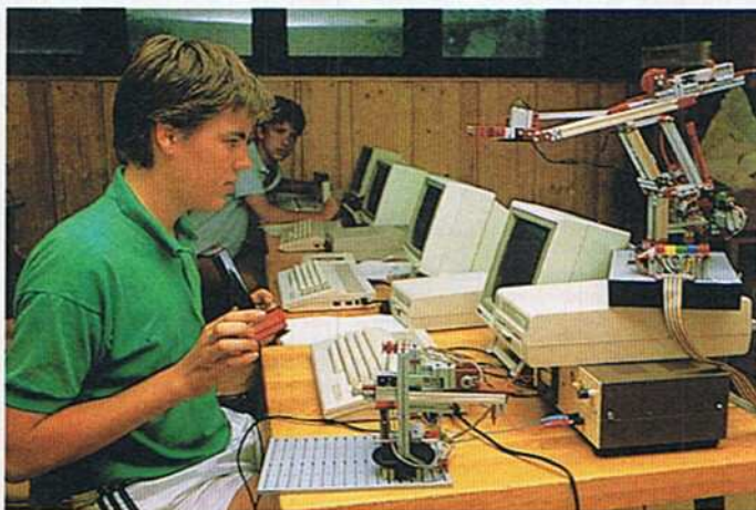
Bild 2. Der C 64 steuert Roboter. Hier am Beispiel eines Fischertechnik-Versuchsroboters
