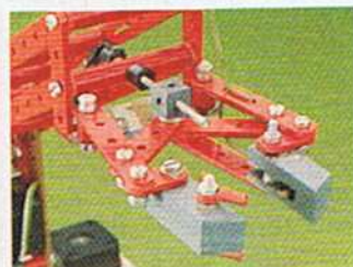
Bild 5(+5a). Der »Unitek-Roboter« kann sich mit seinen Schrittmotoren erstaunlich schnell bewegen. Im Test ist es der einzige C 64-Roboter mit einer Fühleinrichtung im Greifer (unten).
