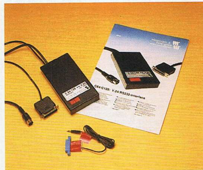
Bild 1. RS232-Interface an der seriellen IEC-Schnittstelle
