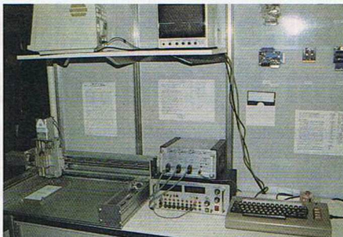
Bild 4. Wer hätte gedacht, daß der C 64 als Steuereinheit einer CNC-Fräsmaschine eingesetzt werden kann?
