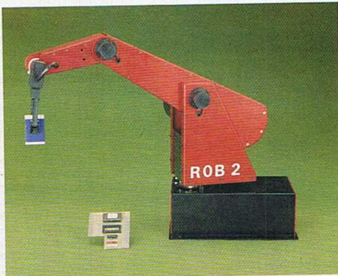
Bild 9(+9a). Der »ROB 2« ist mit sechs Freiheitsgraden der gelenkigste unter den C 64-Robotern. Im Detail unten ist das Getriebe zum Schwenken und Drehen des Greifers zu sehen.
