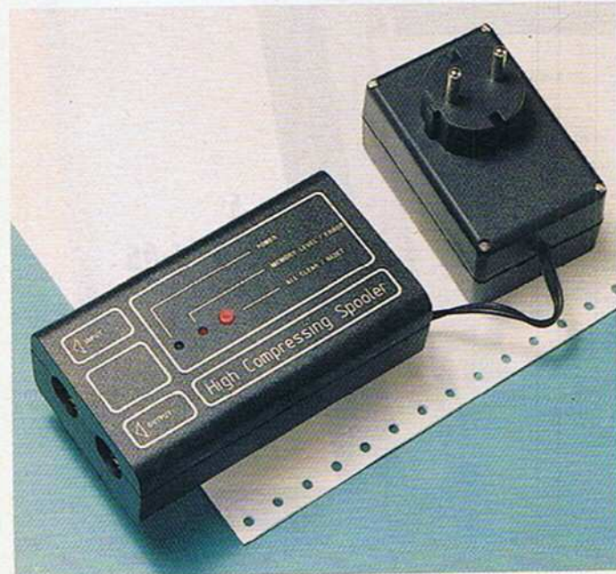
Bild 1. Der neue HCS 64-Druckerspooles von Conrad mit 32 KByte RAM und Netzteil sowie integrierter Datenkomprimierung
