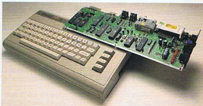
Bild 1. Der neue C 64 und dessen überarbeitete »Innereien«
