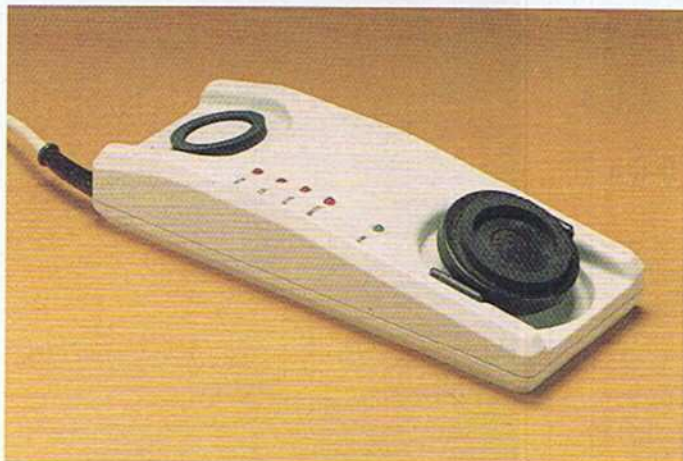
Bild 2. Induktive Koppler benötigen keine Gummimuffen zur Geräuschdämpfung: CTK 2002 (ab 550 Mark)
