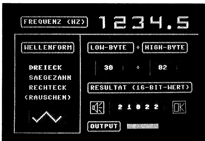
Bild 1. Die komfortable Eingabemaske erleichtert das Arbeiten mit dem Frequenzgenerator.
