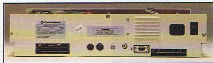
Bild 4. Die Heckpartie des C 128D. Die Buchsen befinden sich jetzt mehr in Bodennähe, und der Anschluß der Datasette wurde von der Gehäuserückseite verbannt.
