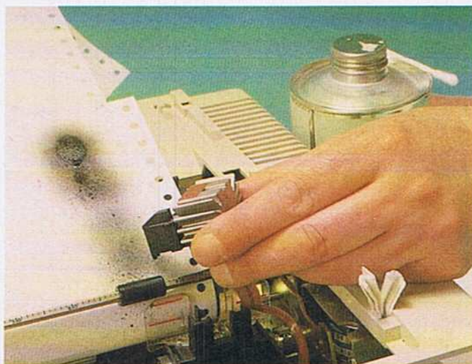
Bild 6. So drucken Sie ins Leere, und der Druckkopf reinigt sich
