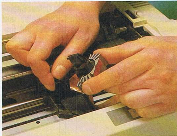
Bild 4. Der Druckkopf läßt sich beim NL-10 besonders einfach, wenn auch mit größter Vorsicht ausbauen
