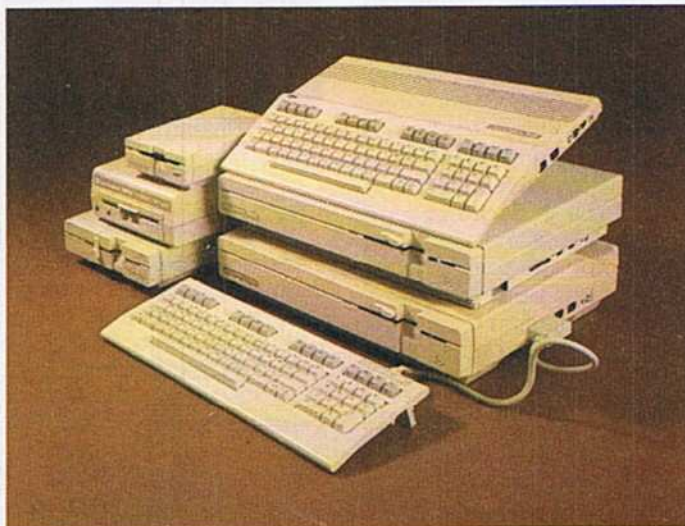
Bild 2. Die C 128-Familie: Der (Ur-)C 128, der erste C 128D, der neue C 128D (Blech) und die Laufwerke 1570, 1571 und 1581
