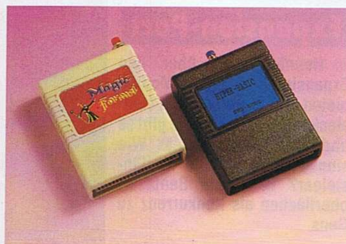
Bild 2. Ein Modul ist im Prinzip eine Speichererweiterung
