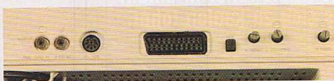
2 Die Schnittstellen und die weniger benötigten Bedienelemente wurden beim KP748 auf die Rückseite verbannt
