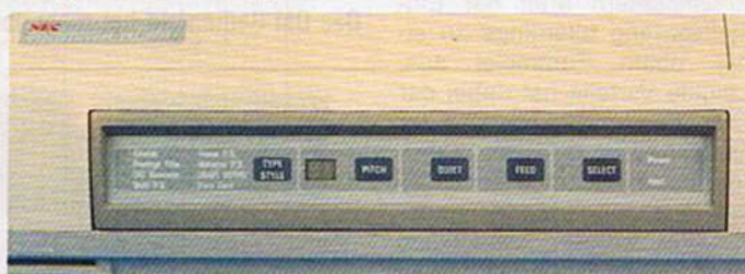
Das Bedienfeld des NEC glänzt mit einem eigenen LED-Display für Schriftenanzeige und Fehlermeldungen
