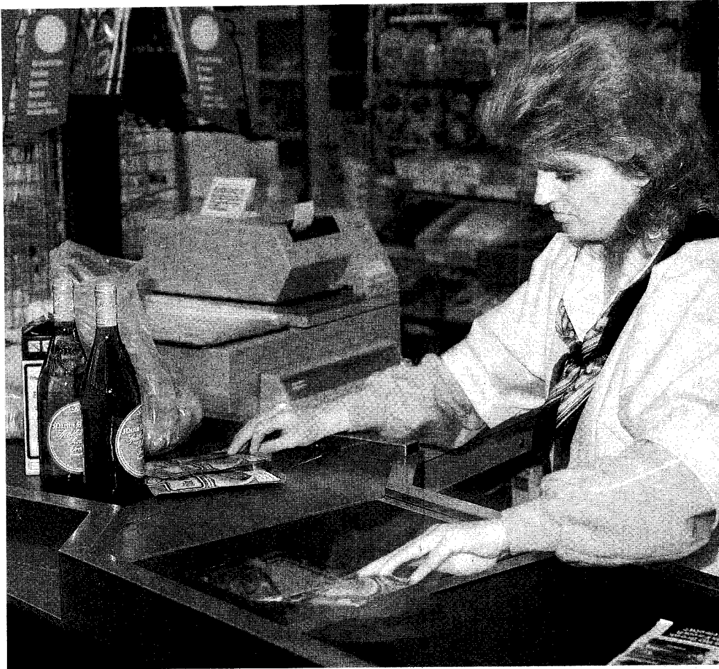
Ähnliches Prinzip, aber »aktive« Hardware mit Barcode-Auswerter: Scanner-Kasse im Supermarkt
