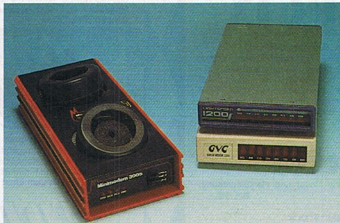
Ein zugelassener Akustikkoppler und zwei verbotene Modems
