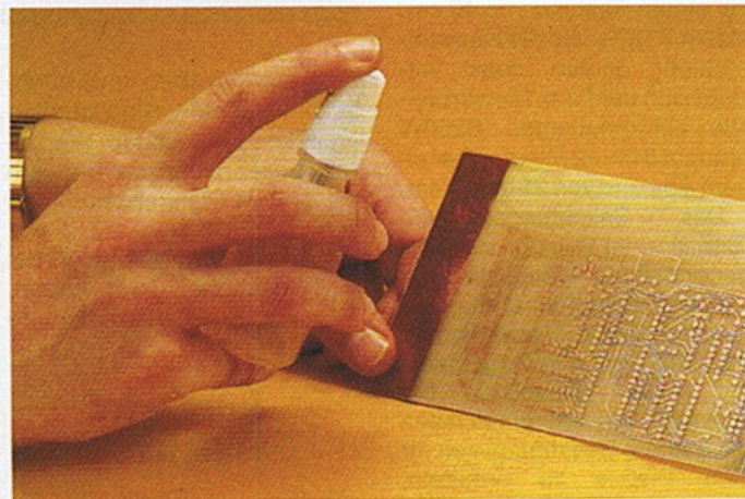
8 Ist die Platine fertig gebohrt, sollte man sie zum Schutz mit Lötlack einsprühen
