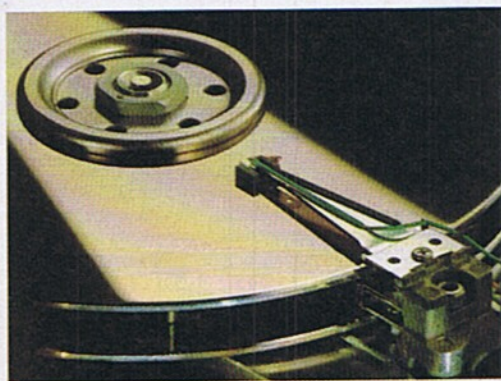
6 Die Köpfe müssen bei einer Festplatte erheblich kleiner sein als die einer Diskettenstation
