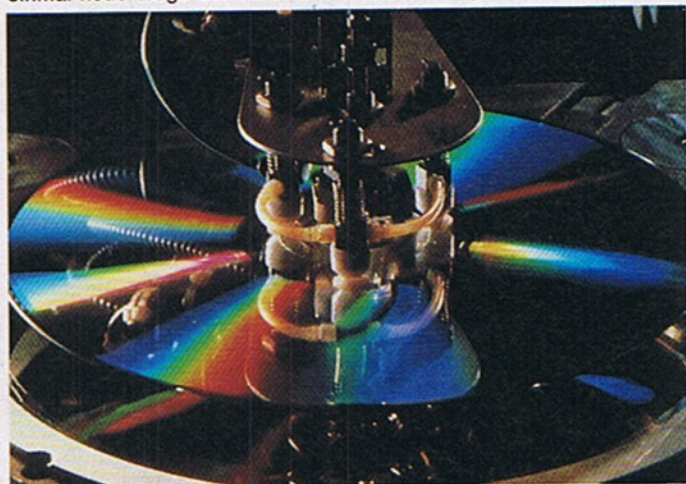
5 Eine CD bei der Herstellung: In diesem Arbeitsschritt wird sie lackiert
