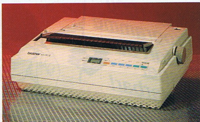
Der Brother M 1818 arbeitet mit 18 Nadeln
