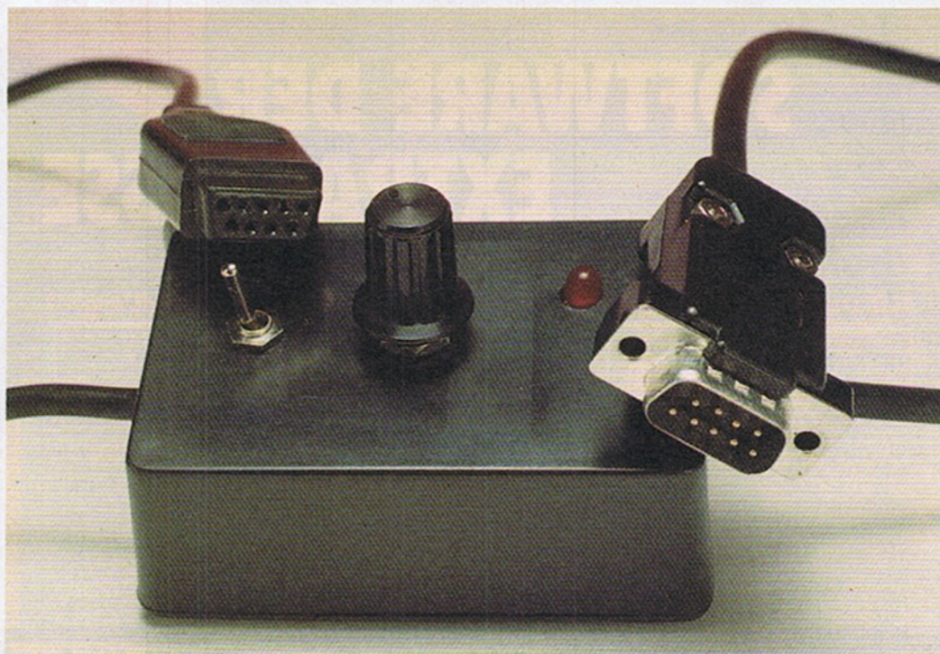
Der Dauerfeuer-Adapter als Zwischenschaltung funktioniert mit jedem Joystick
