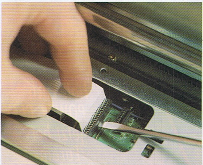
3 Mit einem kleinen Trick läßt sich die Kabelverbindung ganz leicht lösen: Ziehen Sie den Stecker etwas an.
