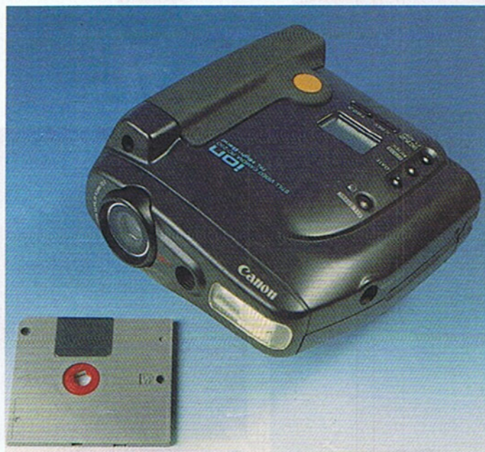
Vom Objektiv direkt auf die Disk: die »Still-Video«-Kamera »ION RC 260« von Canon
