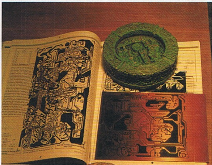
3 Bevor mit dem Belichten angefangen wird, ist es sinnvoll, eine Paßprobe zu nehmen
