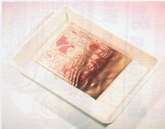
6 Während des Ätzzvorganges muß die Entwicklerschale ständig bewegt werden
