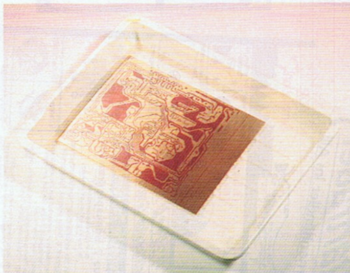
4 Die belichtete Platine verbleibt so lange im Entwicklerbad, bis die Leiterbahnen klar hervortreten
