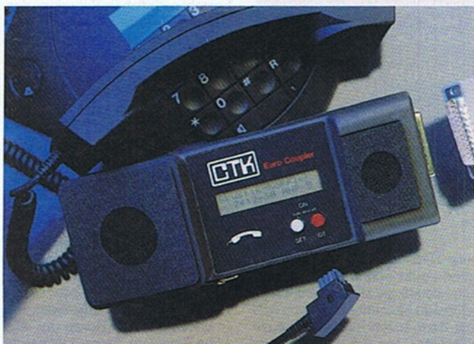
Der »Euro Coupler« von CTK, eine attraktive Koppler-Modem-Kombination mit bis zu 4800 Bit/s
