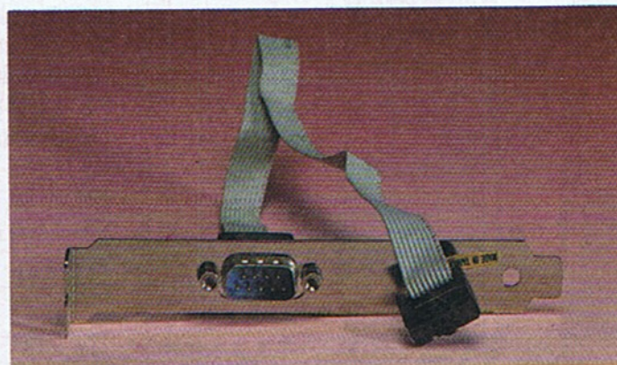
4 Für die Joystick-Ports werden zwei dieser Kabel benötigt
