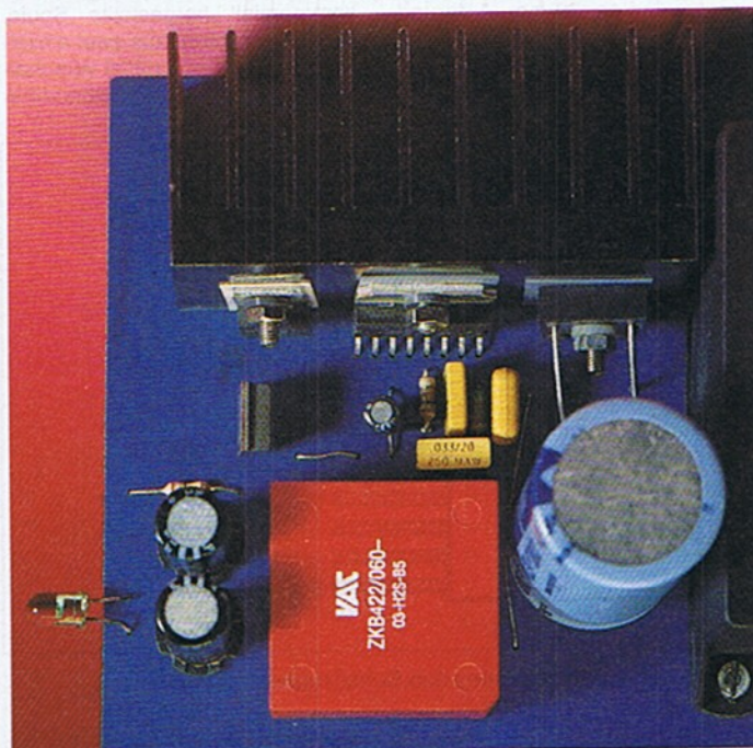
8 Achten Sie auf die isolierte Befestigung der Halbleiter am Kühlblech
