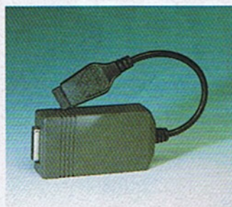
Mit dem Interface läßt sich der PC-Joystick von Cheetah auch am C64 betreiben
