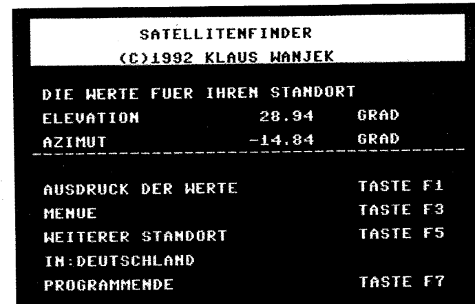
Das Endergebnis: Die berechneten Werte gelten für den Astra und die Stadt Lingen in Niedersachsen
