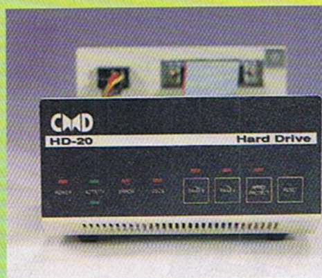
▶ [8] Je nach Gehäuse kann es auch sinnvoll sein, das Laufwerk der HD 20 aus dem Originalgehäuse auszubauen und mit dem Zusatzlaufwerk gemeinsam unterzubringen. Den Controller sollte man jedoch wegen der Schalter und LEDs auf der Frontblende und der Anschlußbuchsen an der Rückwand im alten Gehäuse belassen. In diesem Fall benötigen Sie aber ein längeres SCSI-Kabel.
