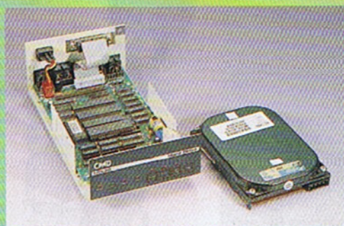
▲ [3] Die HD 20 geöffnet und teilweise zerlegt: Im Gehäuse befindet sich noch die Controller-Platine, rechts daneben das Laufwerk
