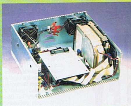
▲ [4] Diese ehemalige Festplattenstation einer SUN-Workstation werden wir demnächst am C 64 betreiben. Sie besitzt eine 71-MByte-HD und ein eingebautes Netzteil.
