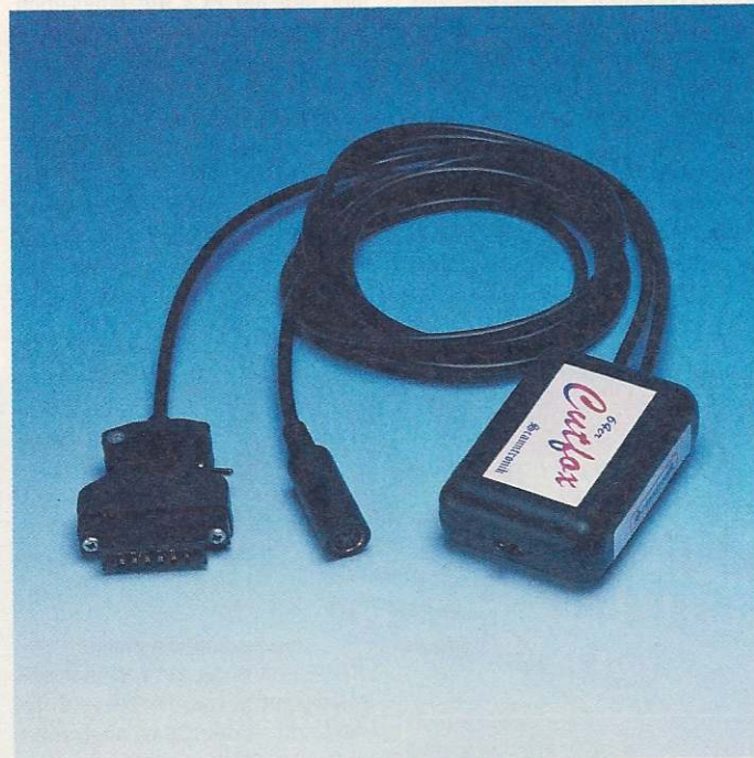
Die Cutfox-Steuerbox mit den Kabeln für den Camcorder und C 64 - sie werden mit der Buchse für die Camcorder-Fernsteuerung bzw. dem Datensetten-Port verbunden - der Expansions- und User-Port des C 64 bleiben für andere Erweiterungen frei
