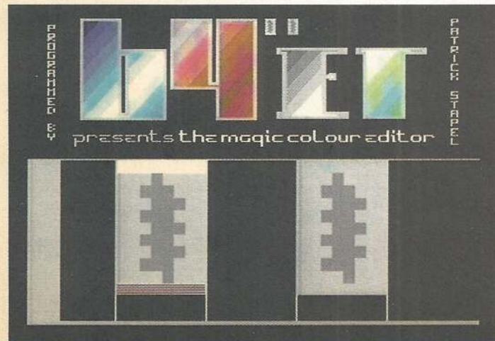
[3] Bei der Kopierfunktion markiert je ein blinkender Strich den gewünschten Block links oben und rechts unten
